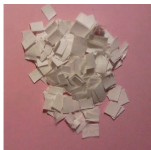
Rysunek 10. Próbkki membran (w postaci rozdrobnionej) wykonanych z: a) PA, b) PVDF
