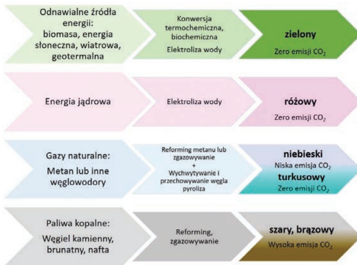
Rysunek 3. Ścieżki produkcji wodoru z różnych źródeł energii
