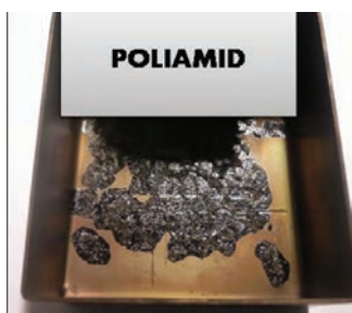
Rysunek 11. Pirolizaty wytworzone w wyniku termicznej obróbki membran z: a) PA, b) PVDF
