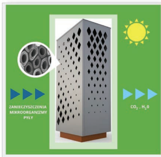
Rysunek 7. Wieża fotokatalityczna do oczyszczania powietrza w aglomeracjach miejskich 94
