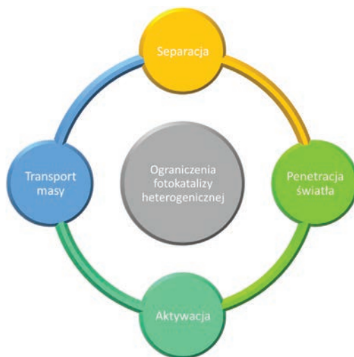
Rysunek 2. Potencjalne wyzwania związane ze zwiększeniem skali procesu fotokatalizy
