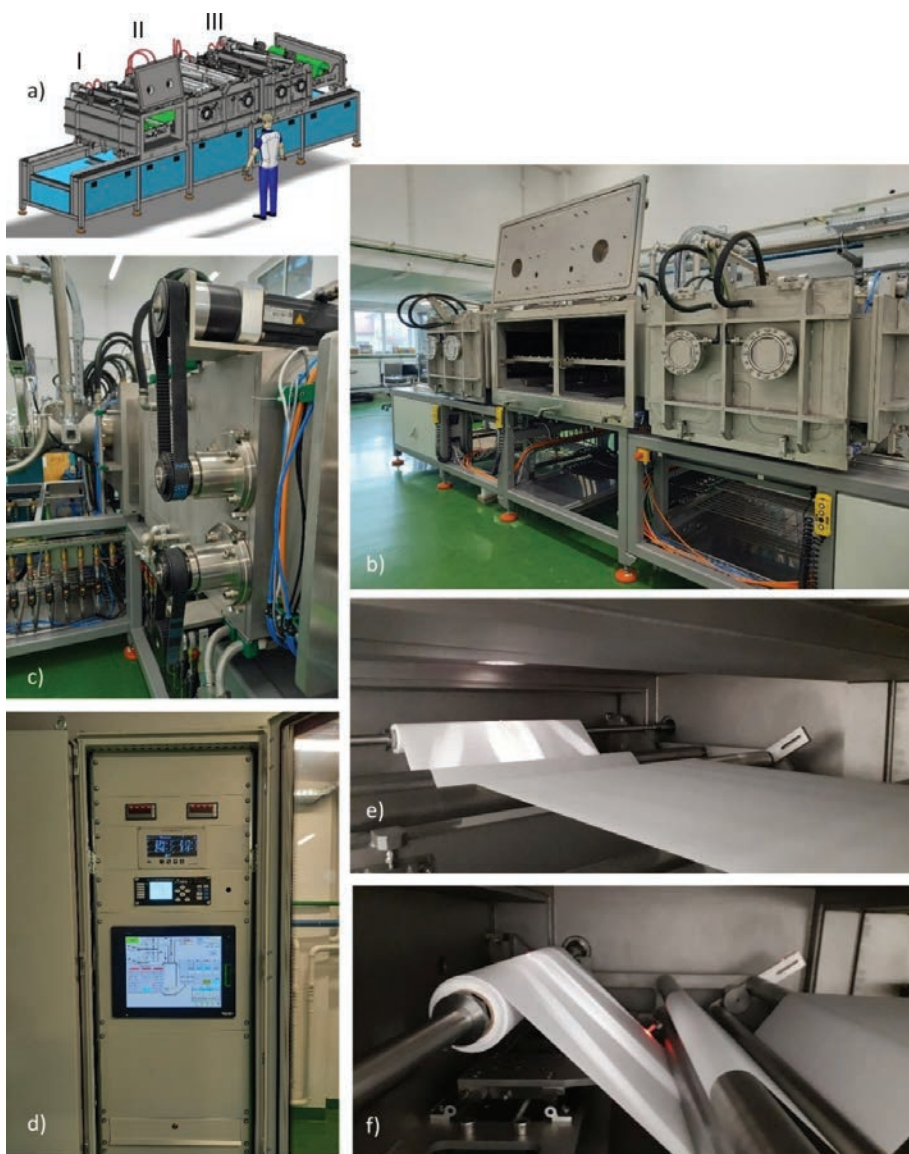
Rysunek 21. Urządzenie technologiczne FLEXline wytworzone w Łukasiewicz – Instytucie Technologii Eksploatacji w Radomiu: a) model 3D, b) widok ogólny, c) nowoczesny system przewijania taśmy f-my REXROTH, d) komputerowy system sterowania, programowania i kontroli parametrów procesowych, e) system przewijania i naciągu taśmy polimerowej pokrywanej powłoką, f) laserowy system kontroli przewijania taśmy polimerowej
