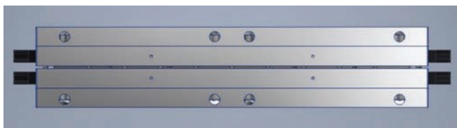
Rysunek 4. Widok wymiennika ciepła dla ogniw termoelektrycznych typu ciec–ciecz
