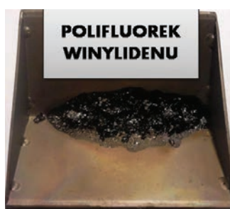
Rysunek 11. Pirolizaty wytworzone w wyniku termicznej obróbki membran z: a) PA, b) PVDF
